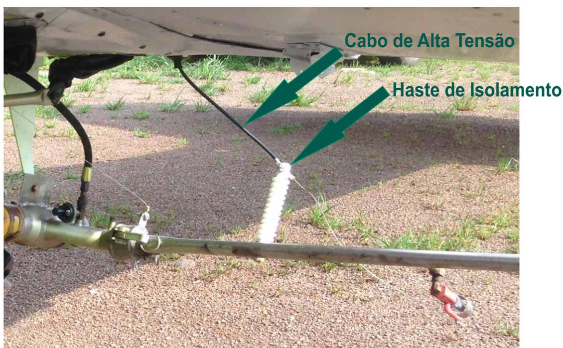
A manutenção da limpeza da haste de isolamento é importante para o perfeito funcionamento do sistema eletrostático, pois a alta tensão precisa permanecer isolada da estrutura da aeronave, ficando apenas em contato com a haste de isolamento e com o eletrodo dos bicos de pulverização.
